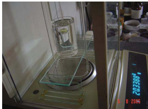
Figura 15: Fotografia do aparato experimental para medida de densidade
